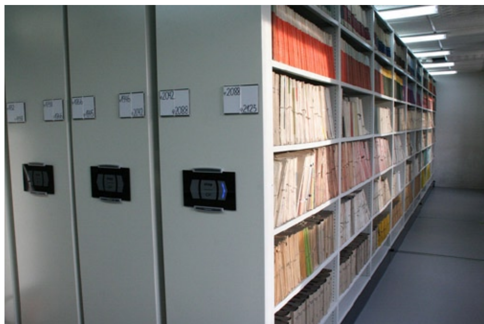
Rys. 23. Regały o długości 9 m przesuwane elektrycznie
